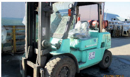
Вилочный автопогрузчик Mitsubishi FG35T. Газ-бензиновый. Грузоподъемность 3,5 тонны, Высота подъема - 3 метра (двухсекционная мачта), АКПП, 2002г, Работает и на газу и на бензине.
