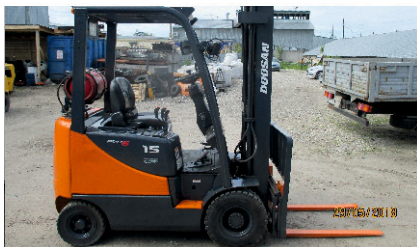
Вилочный автопогрузчик Daewoo Doosan G15-S. Газ-бензиновый. Грузоподъемность 1,5 тонны, Высота подъема - 6 метров (трехсекционная мачта вагонного типа), АКПП, Сайдшифтер (боковое смещение каретки), колеса суперэластик, 2008г, ПСМ в наличии.
